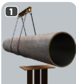
1 Préparation de la surface Sa2½ / St3 et rugosité Rz > 60 µm
